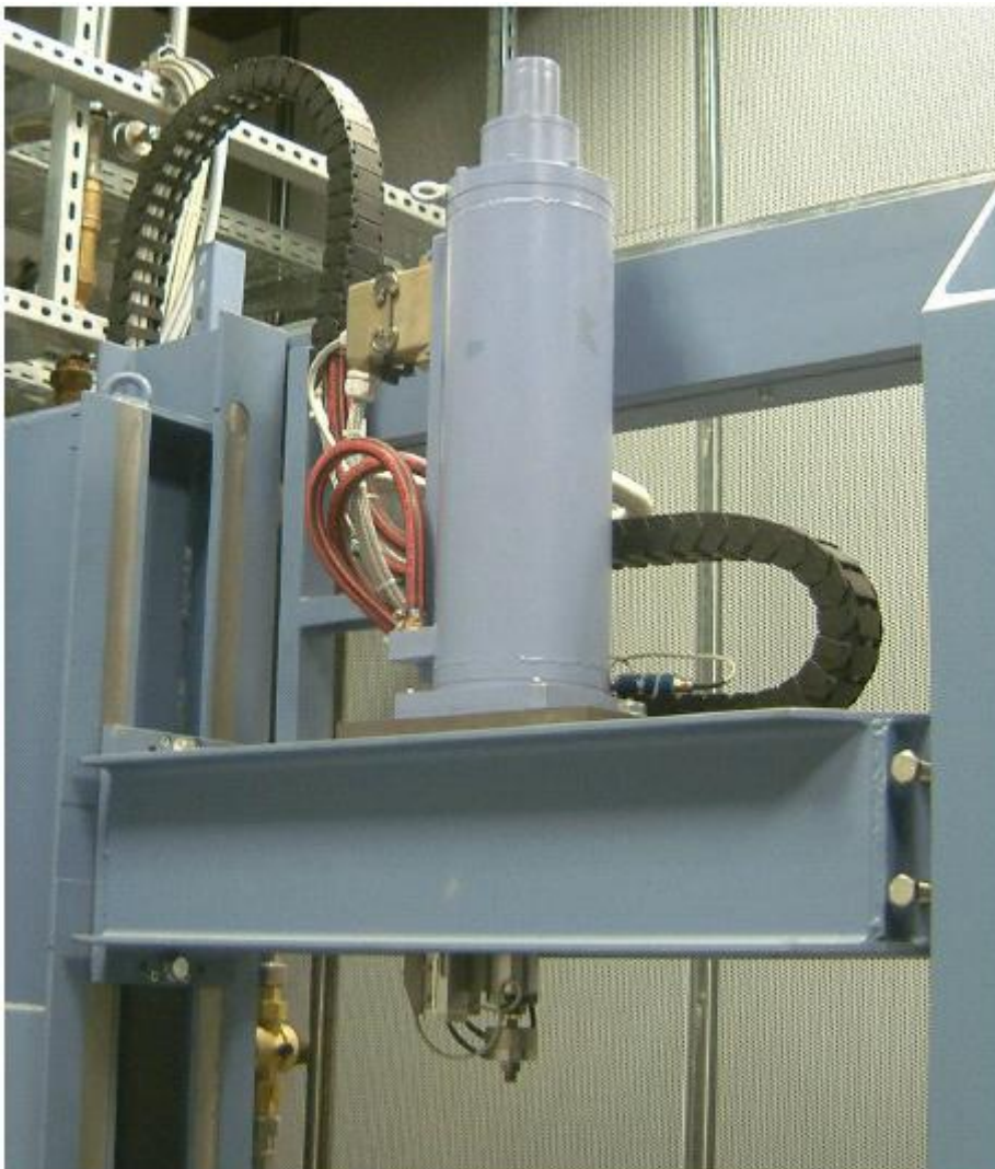
Bild: Biegewechselprüfstand mit Linearmotor
